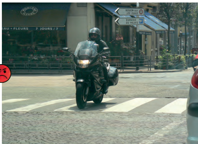
Bandes rapprochées laissant peu d'espace au passage des roues.
