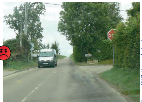
La végétation masque en partie le panneau STOP. Il est encore moins visible car placé en retrait.
