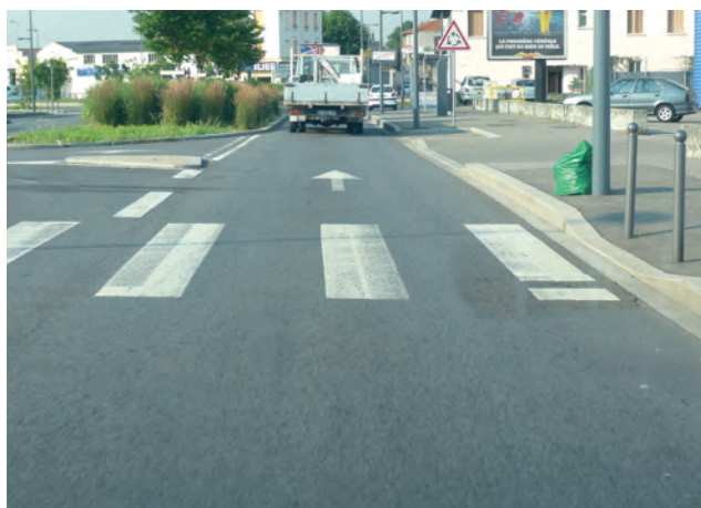
Bandes espacées plus confortables pour un 2RM.
