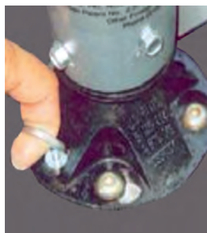
Retrait de la goupille pour le démontage.
